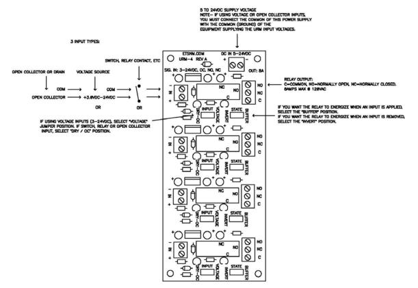
ANY URM SERIES RELAY MODULE. 4 POSITION UNIT SHOWN.
